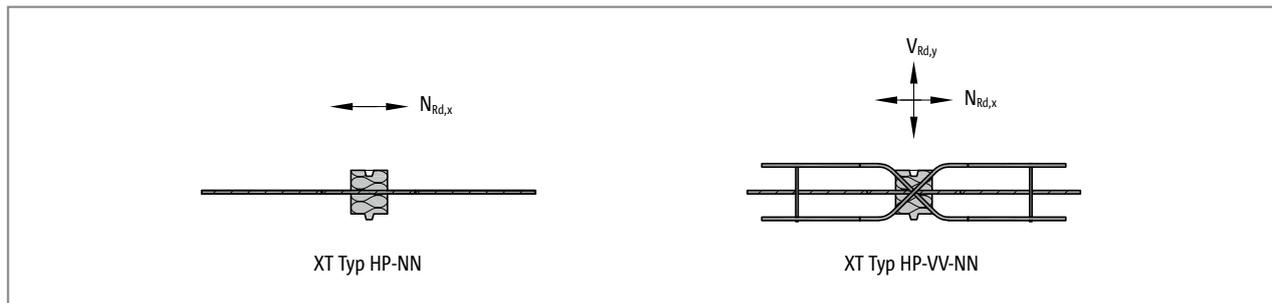
Abb. 43: Schöck Isokorb® XT Typ HP: Typenauswahl
