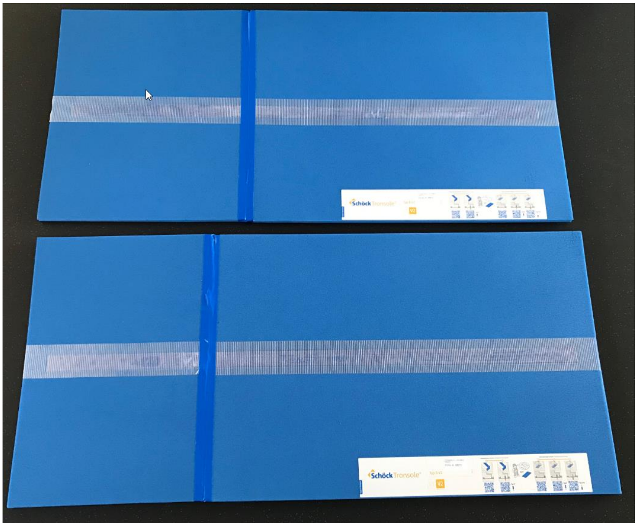
Abbildung 5: Geprüfte Schöck Tronsole® Typ B-V1-L1300 (oben) und Typ B-V2-L1300 (unten)
