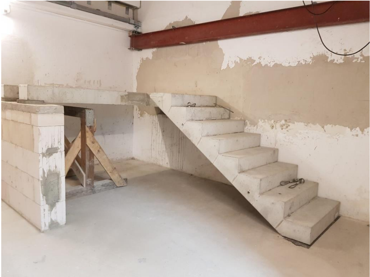
Abbildung 8: Referenztreppenlauf starr an das Referenztreppenpodest angebunden
