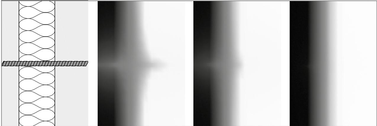
Ill. 25: Schöck Isolink® type TA-H : les graphiques thermiques des ancrages de façade en acier de construction, en acier inoxydable et de Schöck Isolink®
