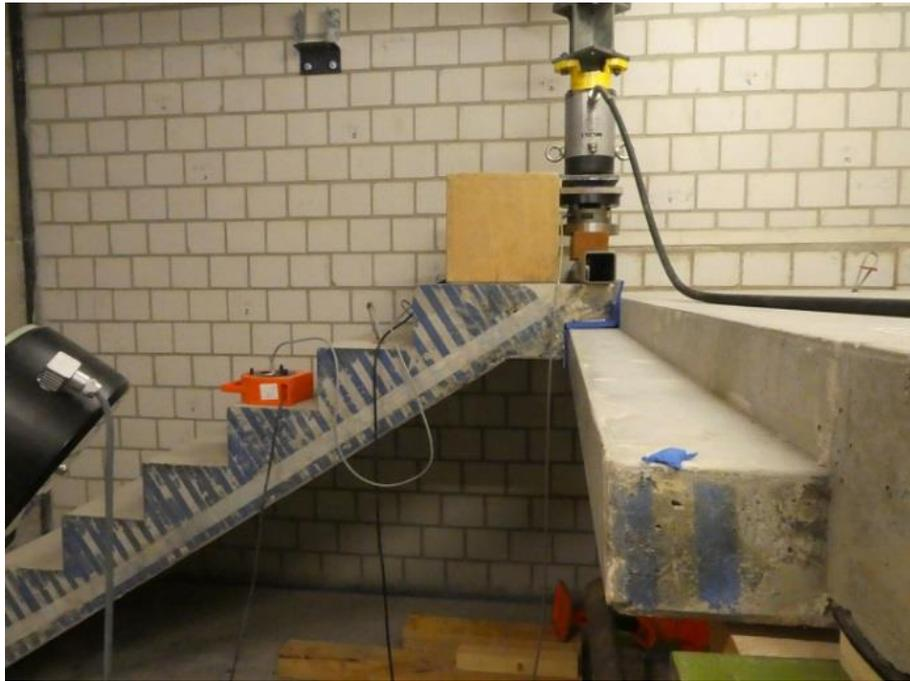
Abbildung 17: Hydraulischer Stempel zum Aufbringen der Zusatzlasten.
