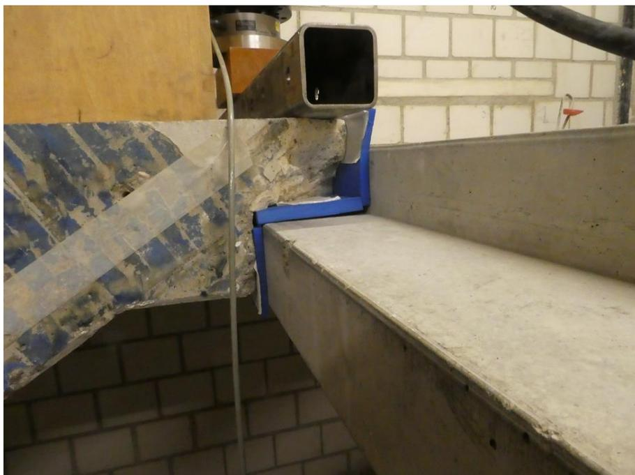
Abbildung 11: Podestkonsole zur Aufnahme des Lagers.
