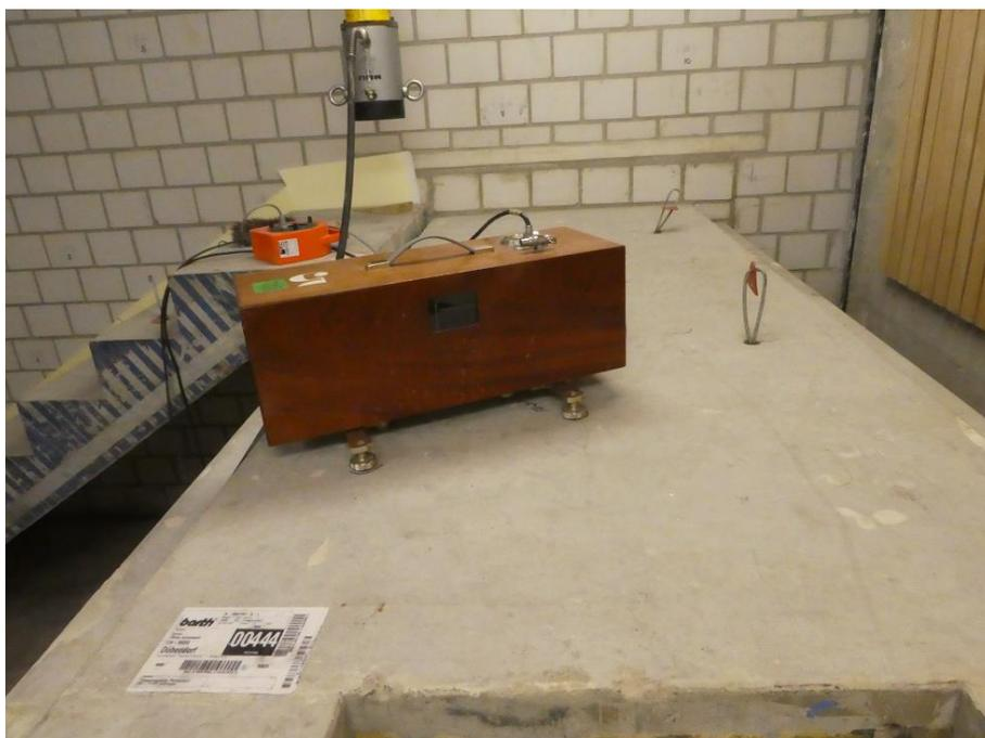
Abbildung 19: eine Hammerwerksposition auf dem Podest.
