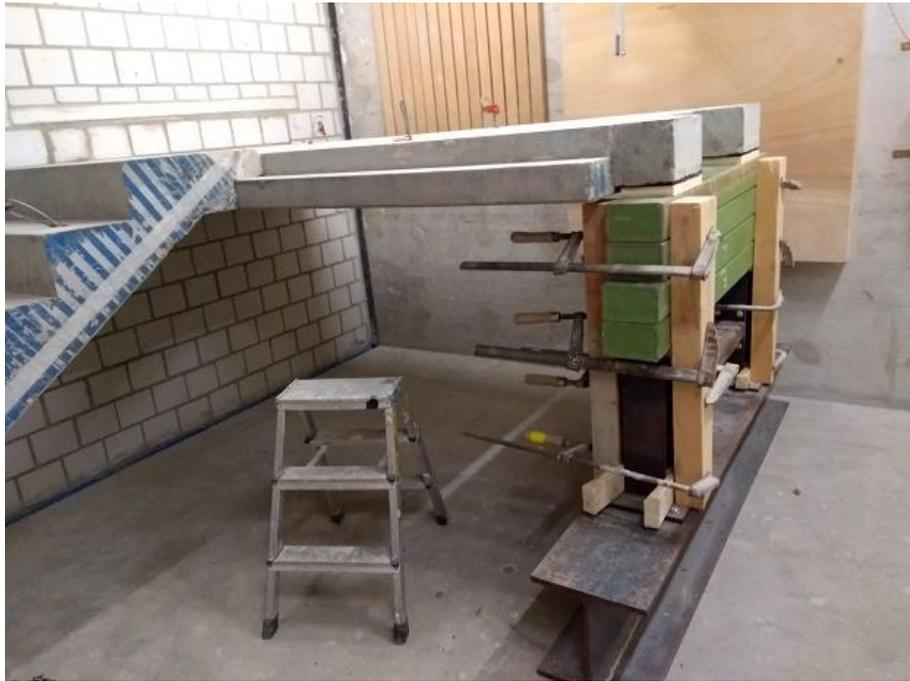
Abbildung 10: Hilfswand mit Entkopplungselementen.
