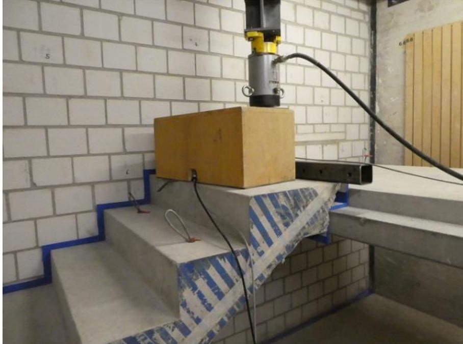
Abbildung 18: Position und Kapselung des Hammerwerks.
