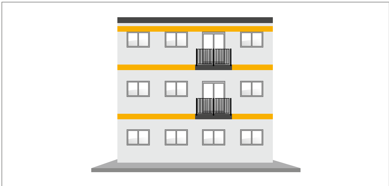
Ill. 2: Disposition des balcons dans le cas d'une protection par bande filante
