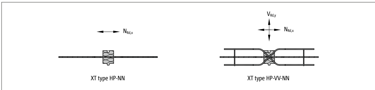
Ill. 134: Schöck Isokorb® XT type HP : sélection du type
